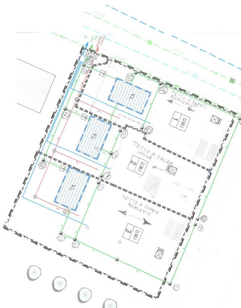
Figura 5 - Schema fognature acque bianche (in verde) e nere (in rosso)
