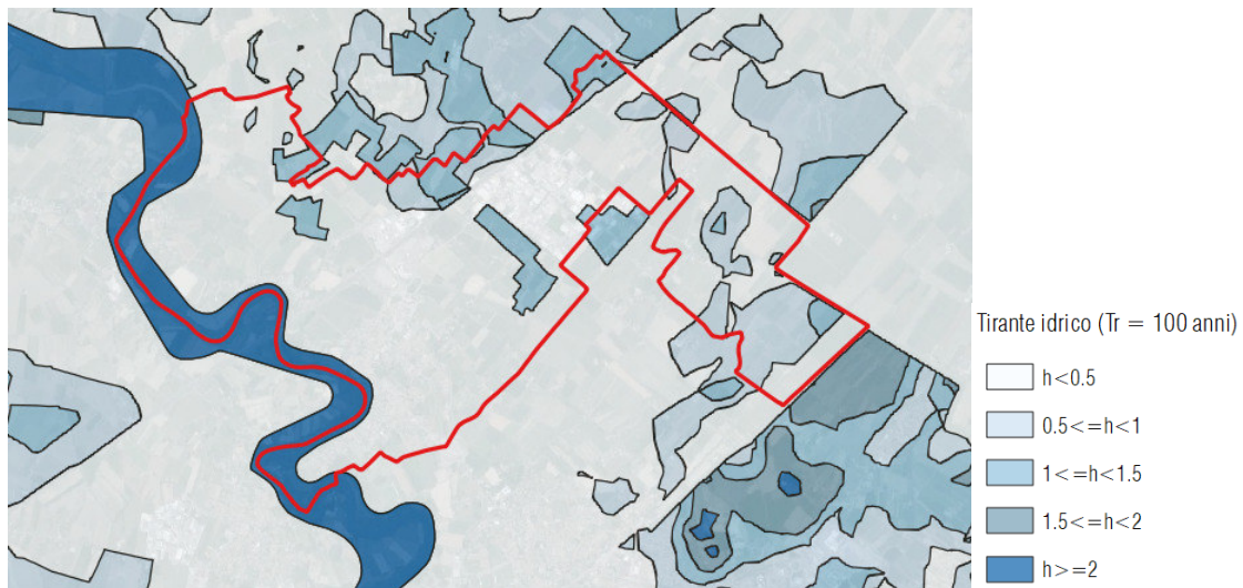
Tiranti idrici stimati per eventi alluvionali con Tempo di ritorno pari a 100 anni secondo il PGRA 2021-2027 (fonte: Distretto Alpi Orientali)
